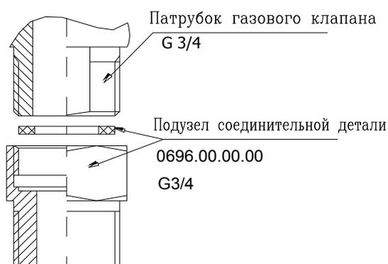
Газовую трубу подключить к патрубку газового клапана котла при помощи подузла соединительной детали № черт. 0696.00.00.00. Как на рис. 3.4.1.
